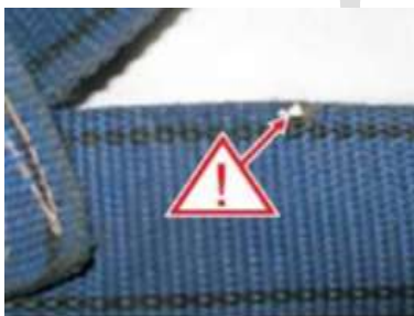
Daño por material fundido SI o NO
